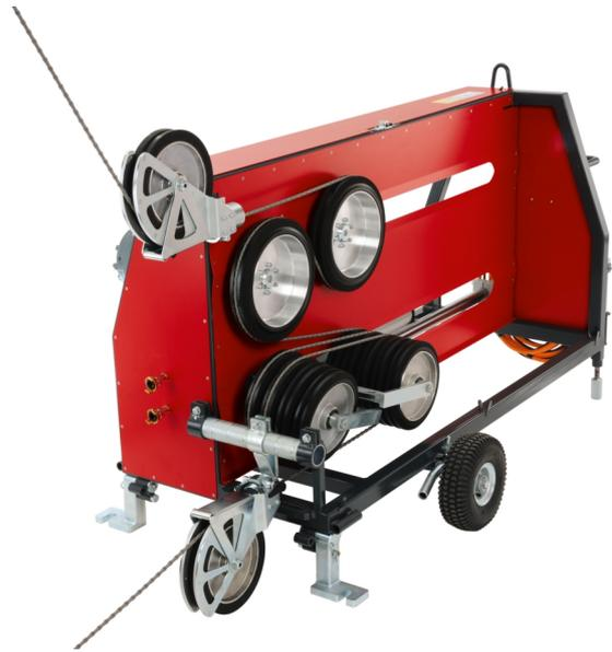
20. Pousser la poulie de guidage inférieure sur le niveau d'occupation correspondant et fixer la poulie de guidage avec la vis.
