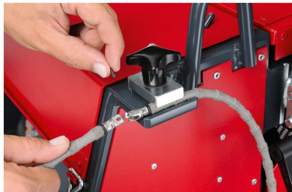
14. Desserrer le levier de blocage du dispositif de verrouillage anti-démarrage.
