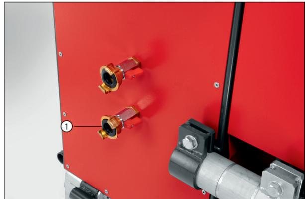
1. En cas de risque de gel ( $< 4\text{ °C}$ ), souffler l'eau de refroidissement hors des moteurs avant les pauses, en fin de journée de travail resp. après le nettoyage.
